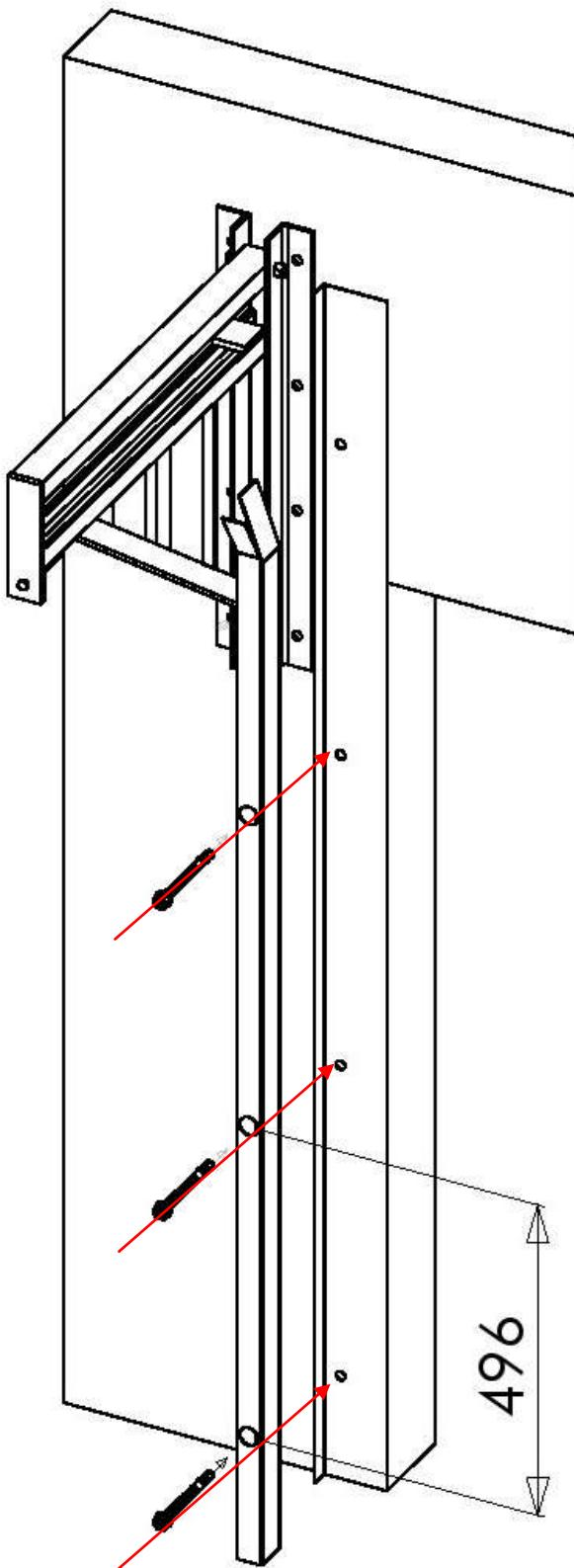
В бетон (кирпич) крепление производится анкерными болтами 8 x 50 мм. К металлоконструкциям возможно крепление либо при помощи сварки, либо саморезами с шестигранной головкой D10.
