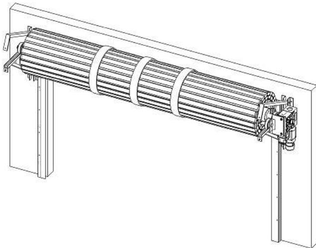
Перед установкой удостовериться в правильной намотке полотна и установке электропривода на валу. Поднять полотно при помощи лебёдки (тали) и вставить подшипниковые узлы в направляющие консолей. Застопорить подшипниковые узлы в консолях. Проверить вращение рулона при помощи рукоятки аварийного подъёма. Разрезать упаковку рулона и заправить полотно в направляющие.
